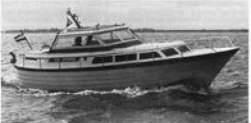
Marex 32 Alm. 10,00 x 3,30 x 1,00 m 6/7 kooien ▲ Gew. 3000 kg 125 PK/91kW Cock in Seizaan- uitvoering
